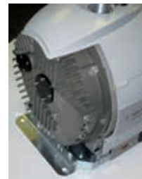
El carenado exterior actúa como protector del ruido
